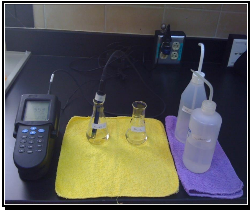
شكل (3) عملية قياس الرقم الهيدروجيني باستخدام جهاز pH meter
