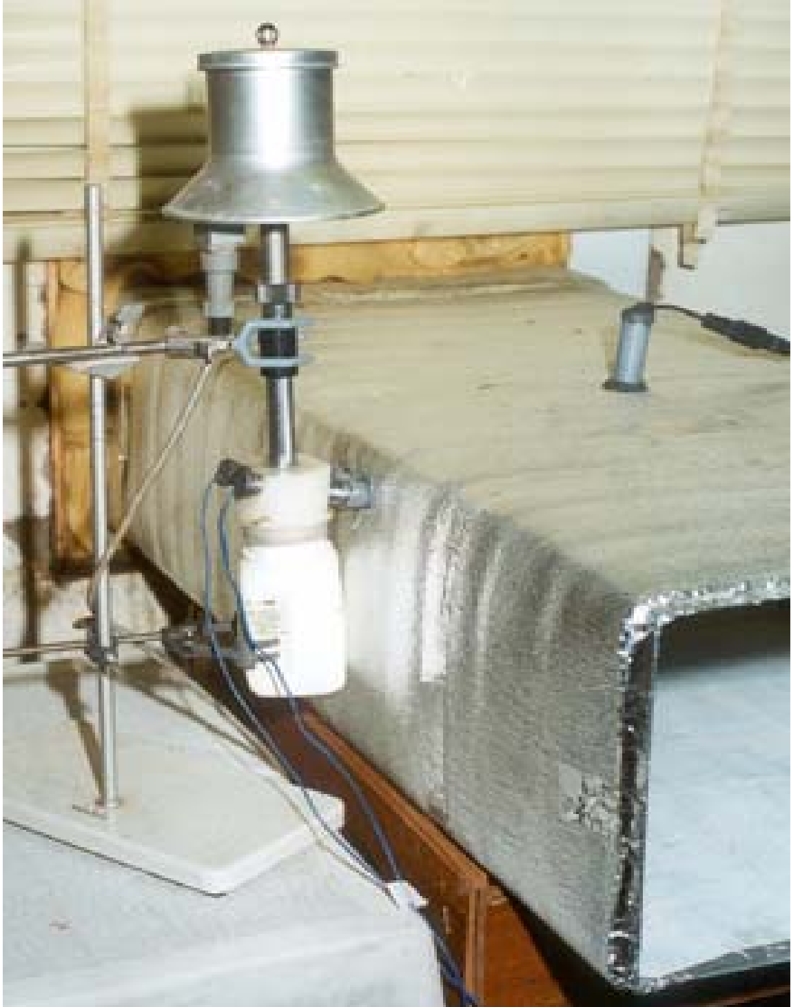
شكل 1. وضع مجسات الترموكابل لقياس درجة حرارة الترمومتر الجاف والمبلل داخل جهاز به مروحة لشفط عينة من الهواء الخارج من المكيف على المجسات.
