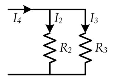
$$I_2 = I_4 \frac{R_3}{R_2 + R_3}$$
