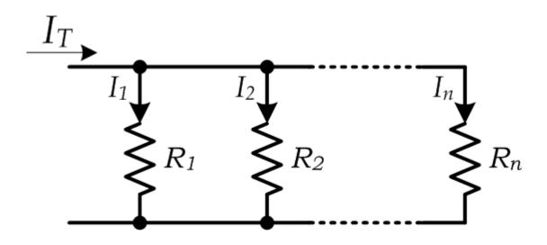
$$R_p = R_1 // R_2 // \cdots // R_n$$
